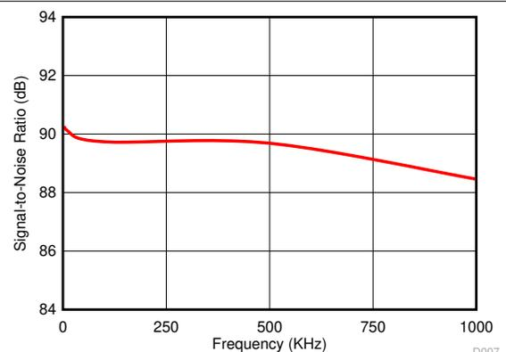
图 6-9. SNR vs Input Frequency
