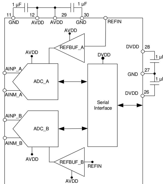
图 9-1. Power-Supply Decoupling
