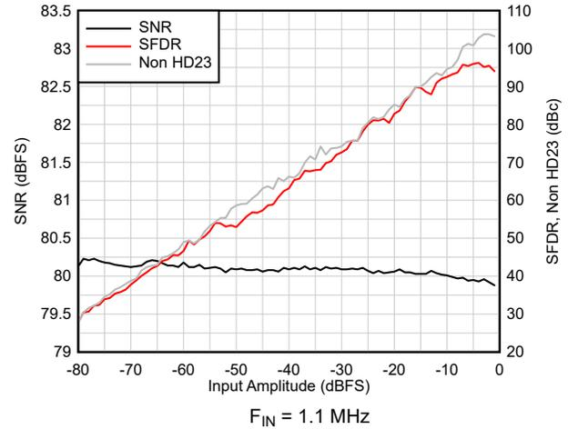
图 6-25. AC Performance vs Input Amplitude
