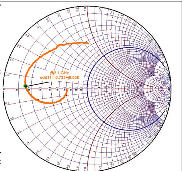
图 8-2. SDD11 Over the Input Frequency Range
