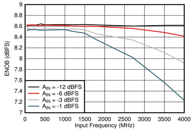
图 7-18. ENOB vs Input Frequency
