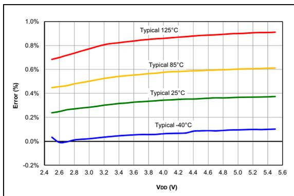
**FIGURE 36-95:** FVR Voltage Error (2x), PIC16F18325/18345 Only
