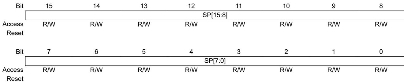
**Bits 15:8 – SP[15:8]** Stack Pointer High Byte
