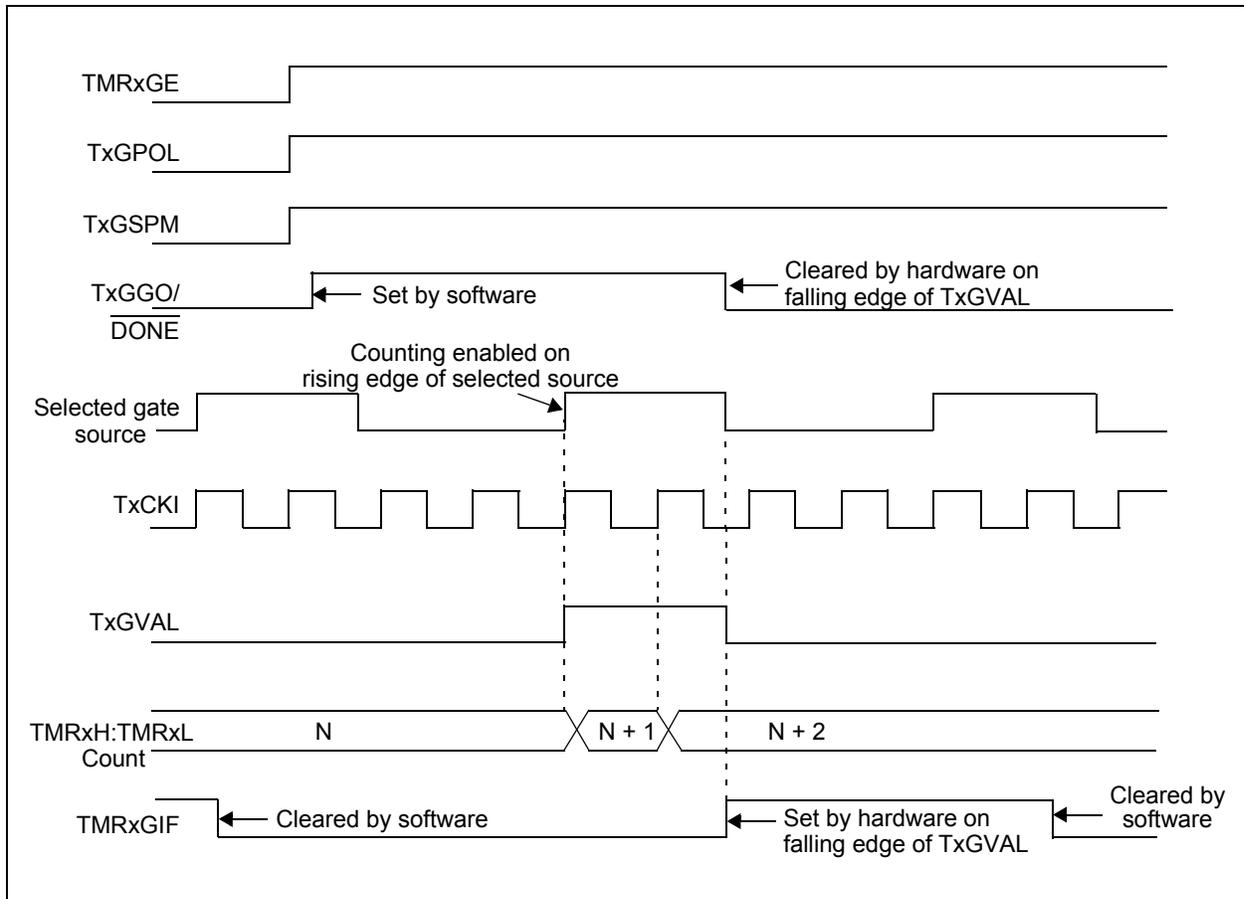
**FIGURE 26-6: TIMER1 GATE SINGLE-PULSE AND TOGGLE COMBINED MODE**
