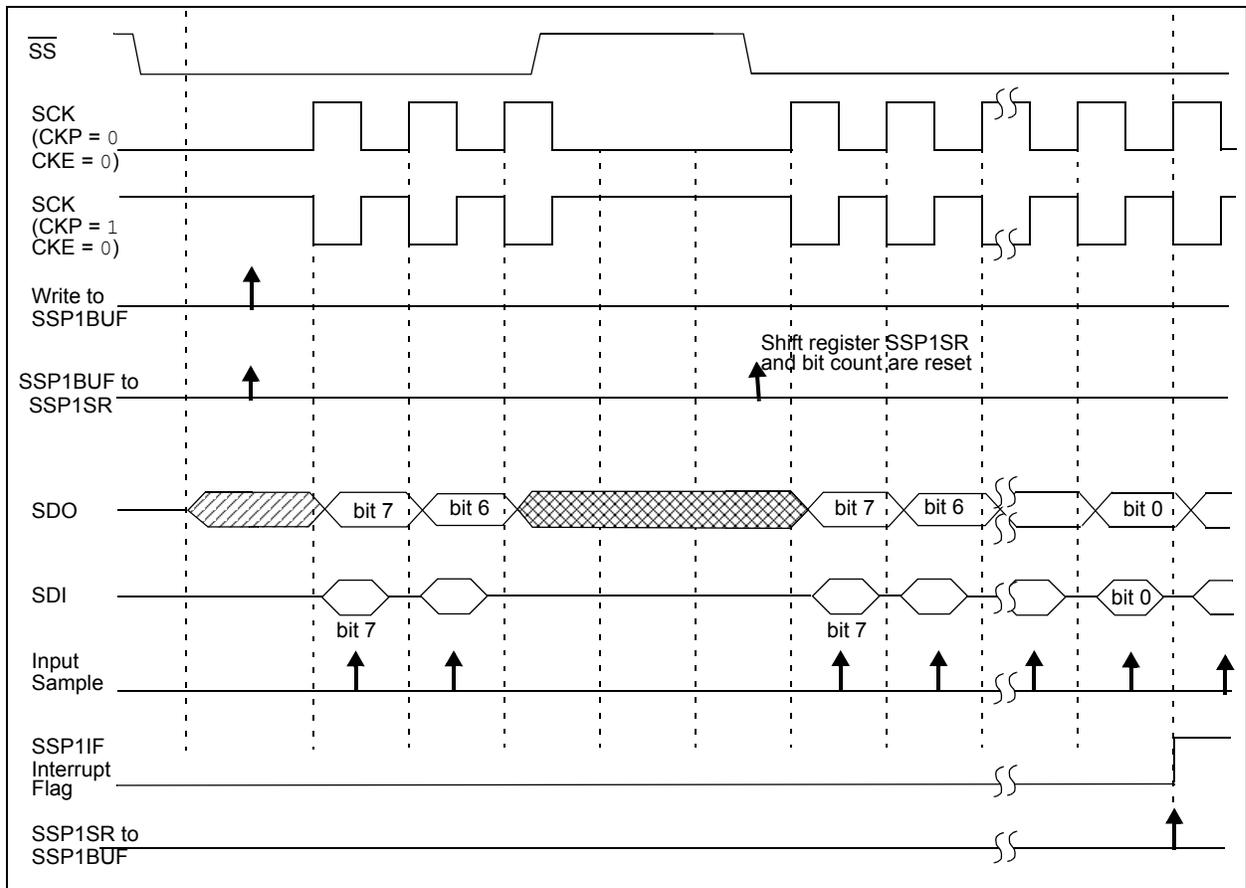
**FIGURE 32-9: SPI MODE WAVEFORM (SLAVE MODE WITH CKE = 0)**
