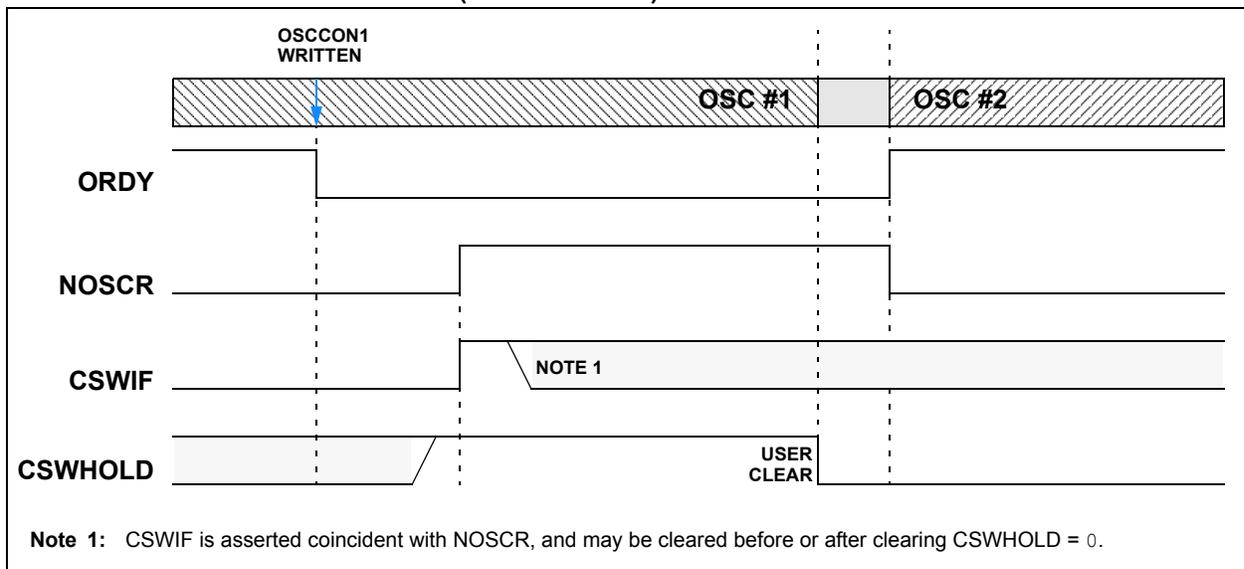
**FIGURE 9-7: CLOCK SWITCH ABANDONED**
