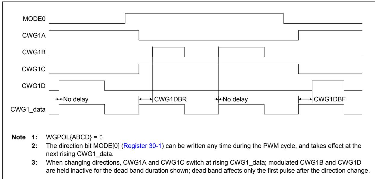
**FIGURE 30-9: CWG HALF-BRIDGE MODE OPERATION**
