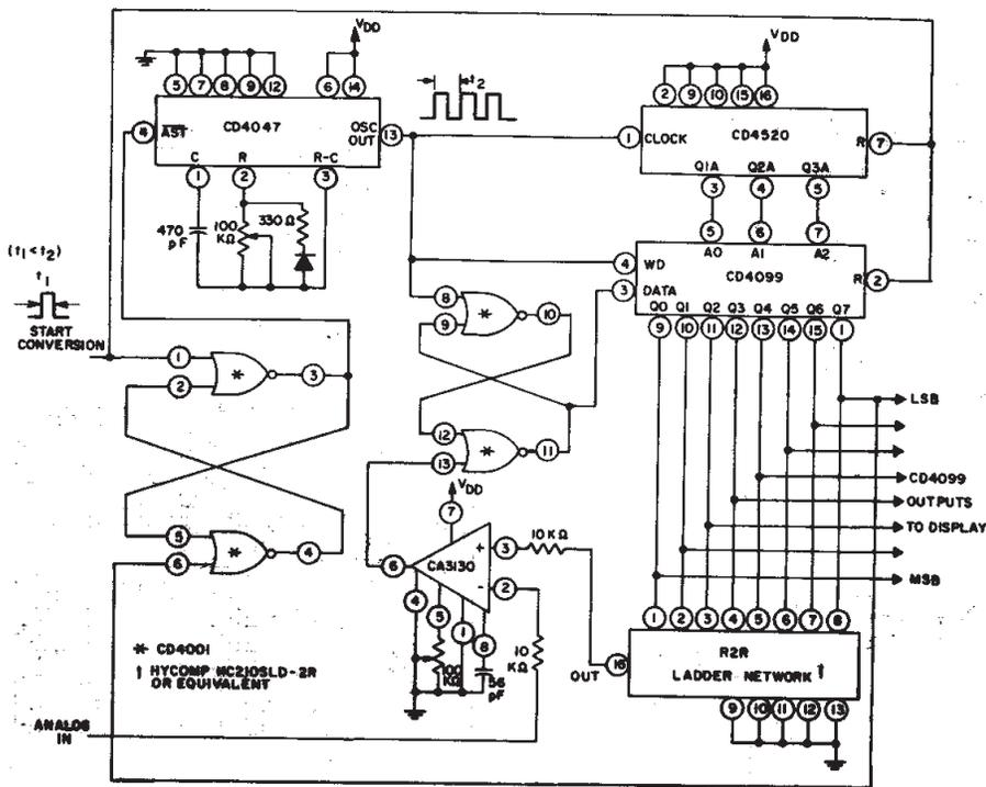
Fig. 5 - A/D converter
