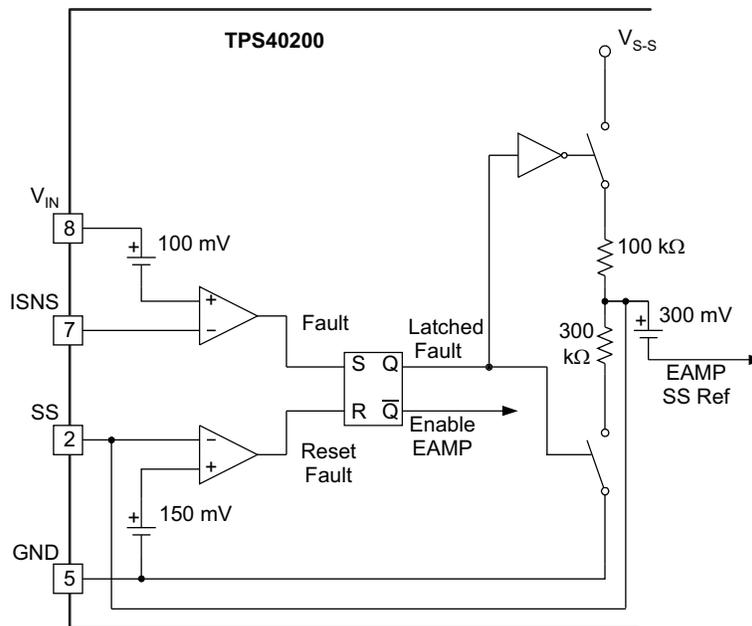
Figure 27. Current-Limit Reset
