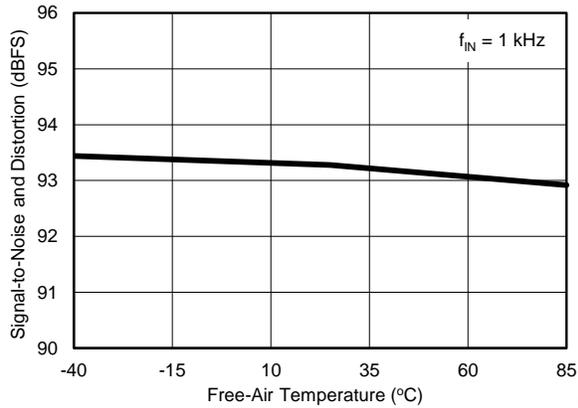
**Figure 24. SINAD vs TEMPERATURE**
