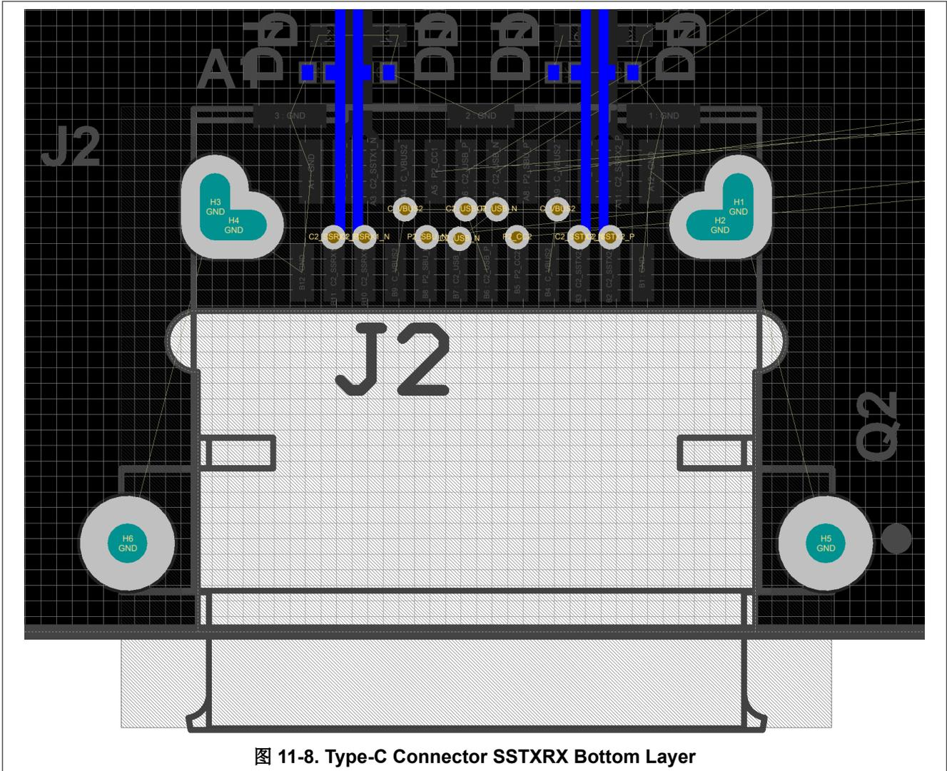
图 11-8. Type-C Connector SSTXRX Bottom Layer
