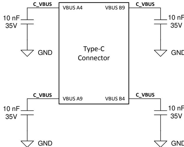
图 9-3. Type-C Connector VBUS Capacitors
