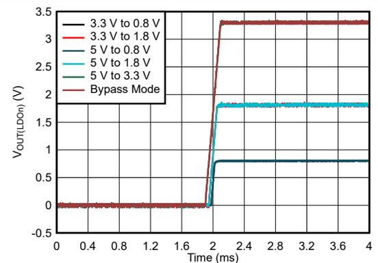
$V_{IN(LDO_n)} = 3.3\text{ V or }5\text{ V}$  TA = 25°C
