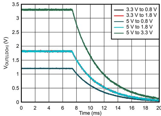
$V_{IN(LDOn)} = 3.3\text{ V or }5\text{ V}$
